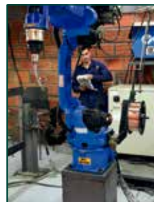
5. Robot MIG welding
