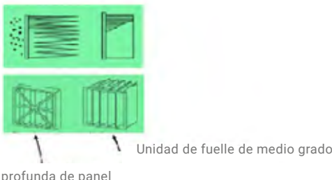
Filtros secundarios (< 2mm).
